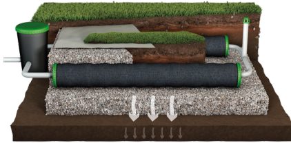
Pack d'infiltration en tranchée
