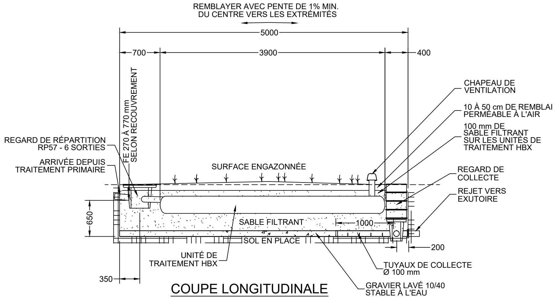
**VENTILATION :** La ventilation primaire et secondaire (équipée d'un extracteur statique) doivent être installées conformément à la norme NF DTU 64.1. La prise d'air à l'extrémité du filtre Enviro))Septic est réalisée par un chapeau de ventilation pour permettre la circulation de l'air vers la ventilation secondaire (extracteur statique). Un différentiel de 3 mètres minimum de hauteur doit être respecté pour garantir la dépression et l'évacuation des gaz par l'extracteur statique.
