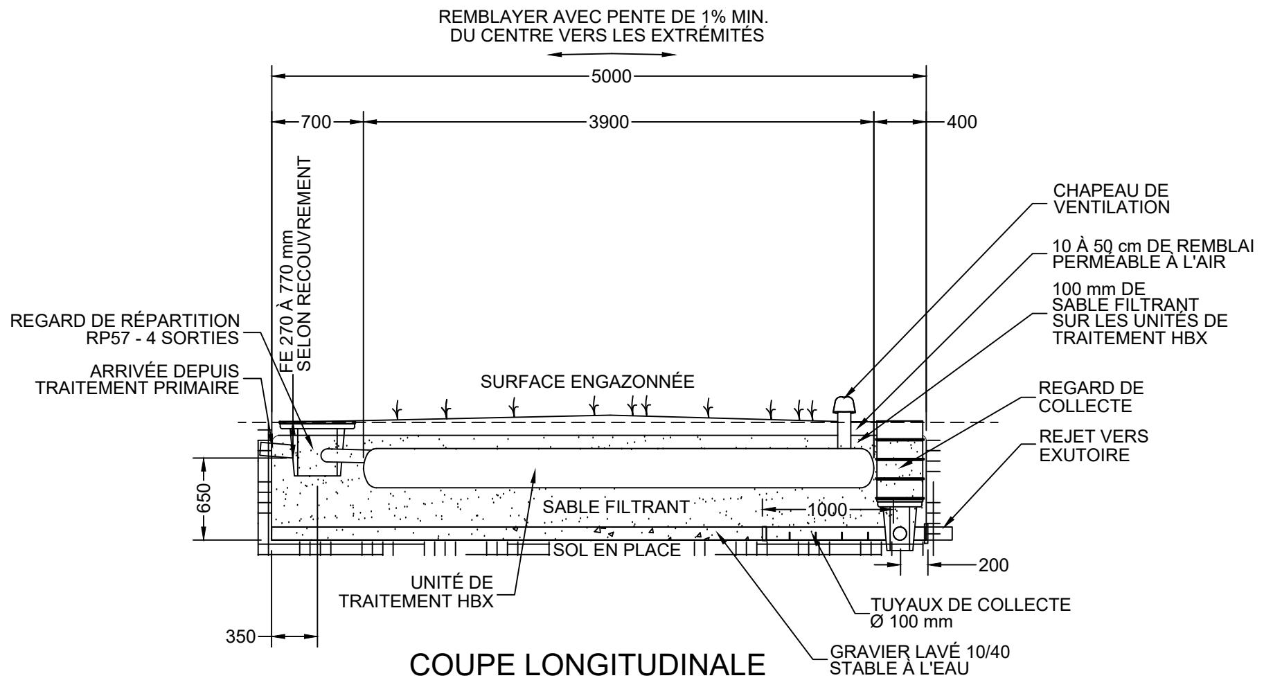
**VENTILATION :** La ventilation primaire et secondaire (équipée d'un extracteur statique) doivent être installées conformément à la norme NF DTU 64.1. La prise d'air à l'extrémité du filtre Enviro))Septic est réalisée par un chapeau de ventilation pour permettre la circulation de l'air vers la ventilation secondaire (extracteur statique). Un différentiel de 3 mètres minimum de hauteur doit être respecté pour garantir la dépression et l'évacuation des gaz par l'extracteur statique.
