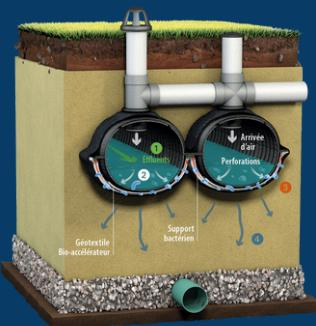
La circulation d'air à l'intérieur des unités de traitement HBX se fait grâce à une ventilation passive intégrée au dispositif.
