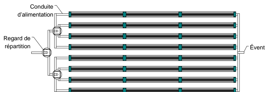
Figure 14 – Alimentation par des regards de répartition en série
