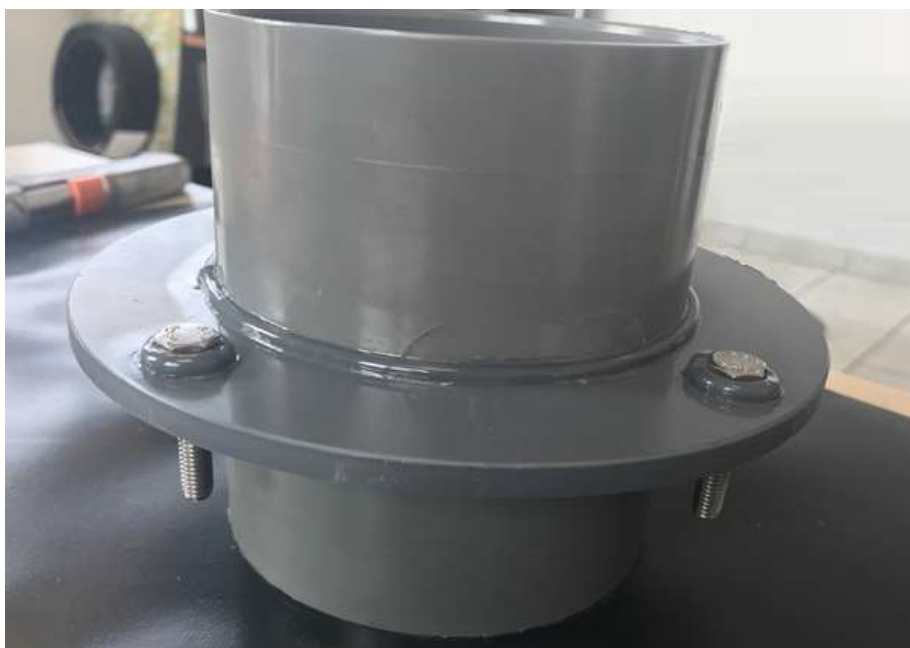
Figure 24 – Mise en place de la collerette étanche
