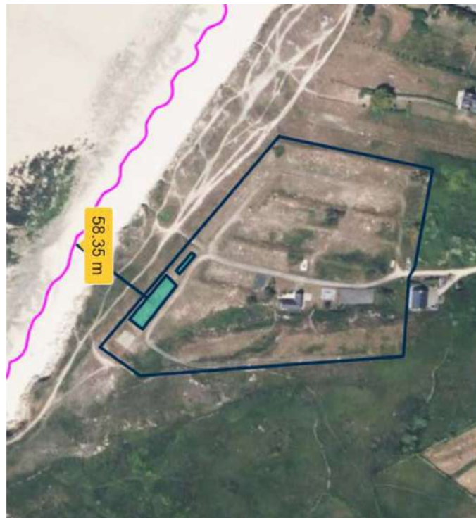
Plan d'implantation de l'unité de traitement Enviro))Septic à environ 60m de la plage
